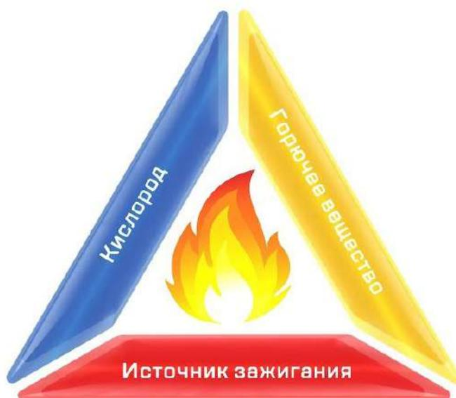
Если убрать один из этих компонентов или нарушить связь хотя бы между двумя из них, горение прекратится. На этом принципе основаны все методы пожаротушения.
